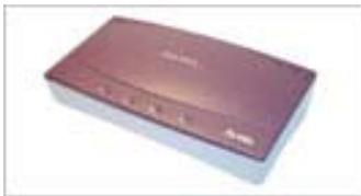
La connessione con il Provider avviene tramite la linea telefonica ed adoperando un modem analogico. Non si può telefonare e adoperare Internet al tempo stesso. La larghezza di banda è al massimo di 56 kb/s. Si paga la telefonata.
